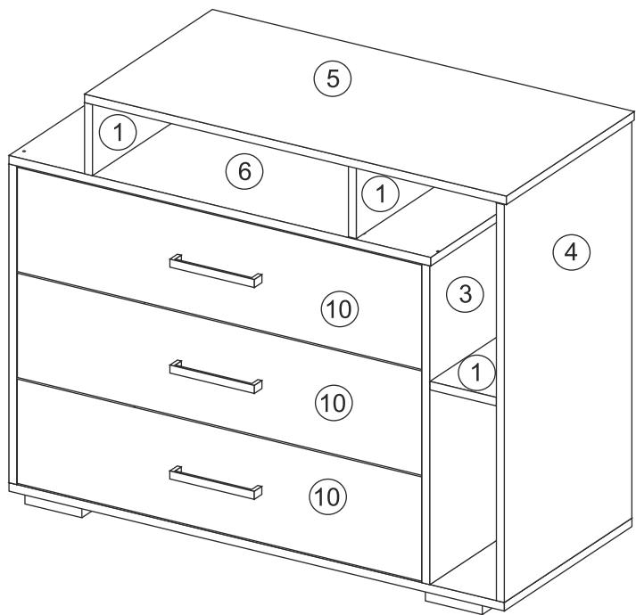
6. Крышку 5 установить на боковины 1 и 4 при помощи шкантов и клея.
