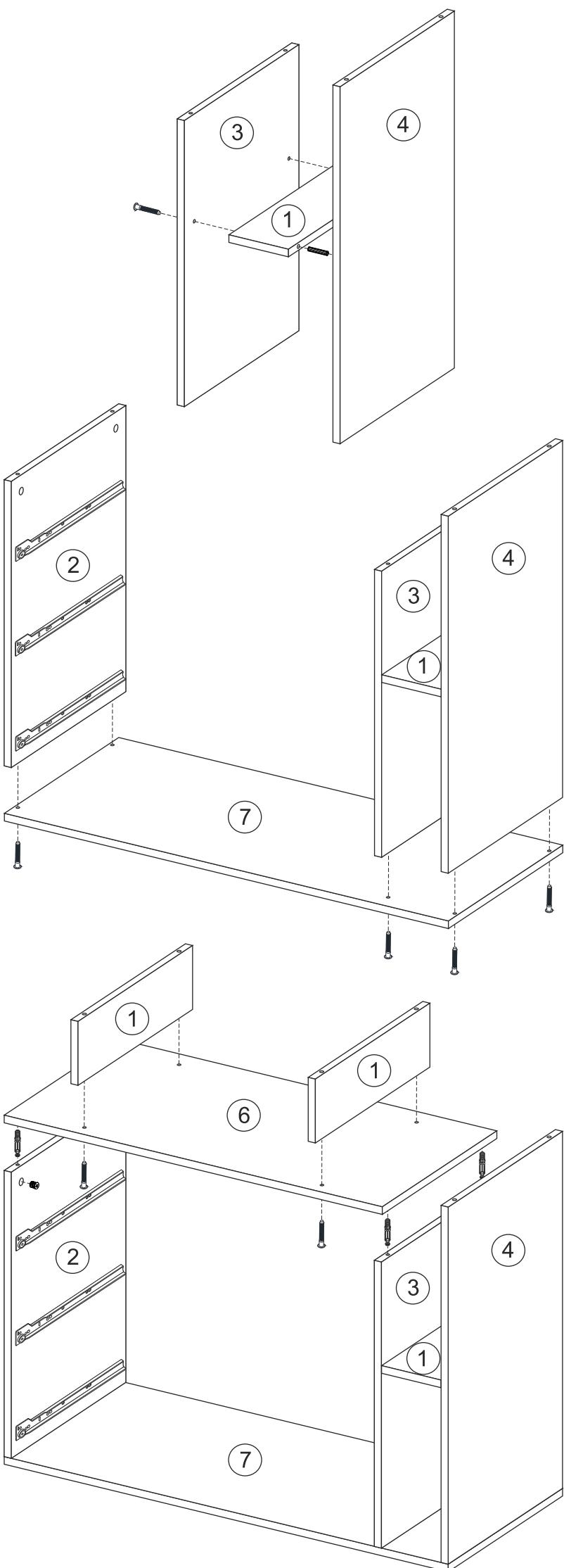
3. Подготовленную боковину 3 и боковину 4 скрепить между собой боковиной 1 при помощи шкантов, посаженных на клей, и еврошурупов 7\*50 мм и шкантов.
